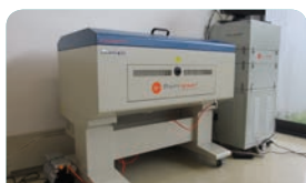
Máquina de corte a laser (25W) - Corte Laser Mercury III 25W
